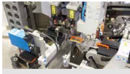
在接触座上部嵌入径向密封圈
