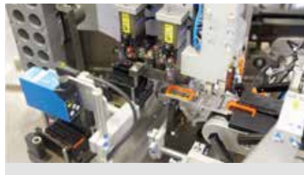
Einsetzen der Radialdichtung in das Kontaktträgeroberenteil
