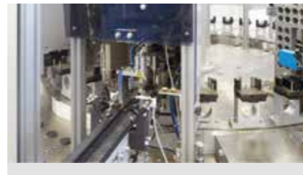
Zuführen und Einsetzen des Kontaktträgerunterteil
