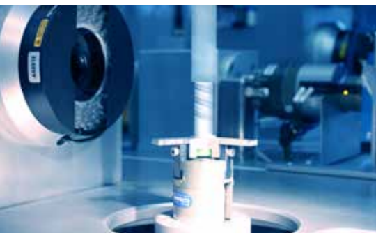
给药装置测试： 扭矩精度可达0.001 Nm 触发力精度可达0.01 N
