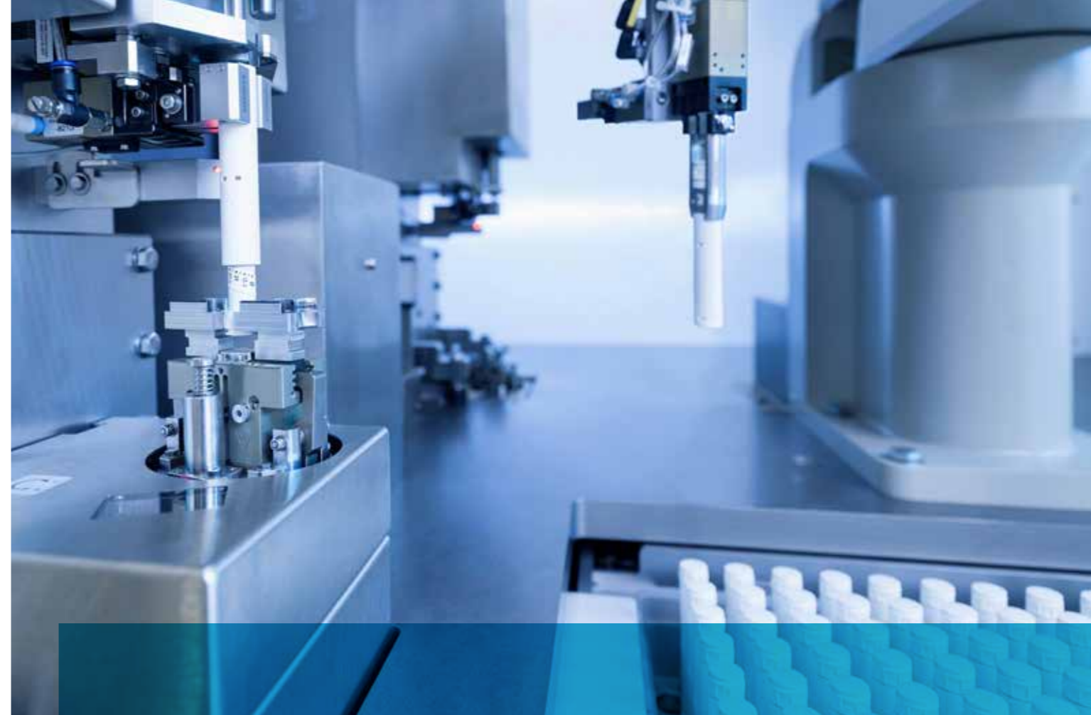
整合全自动装载系统的批量放行测试平台
