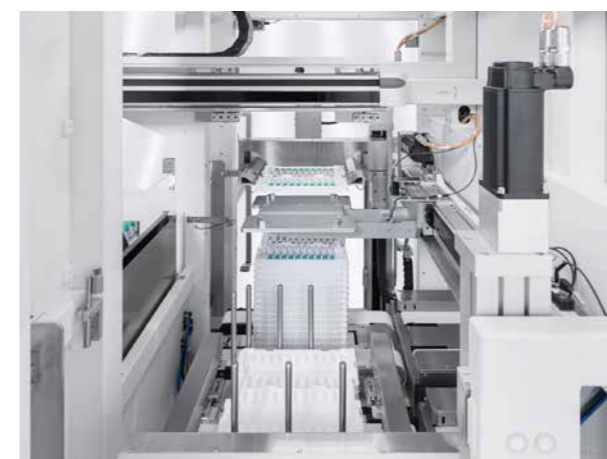
Sichere Trayvereinzeln, selbst bei instabilen Einwegtrays
