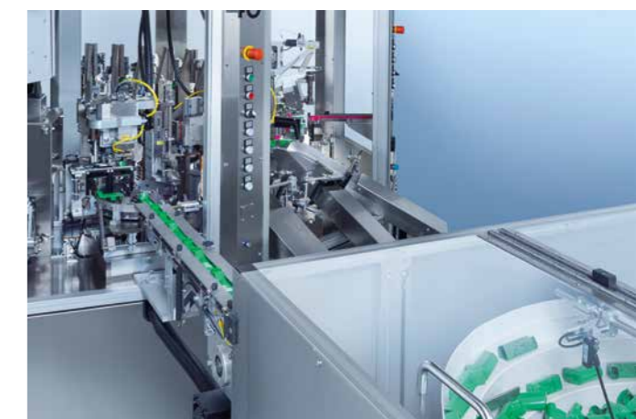
Turnkey-Zuführsystem für Gehäuse mit einer Zuführleistung von 75 Teile/Min.
