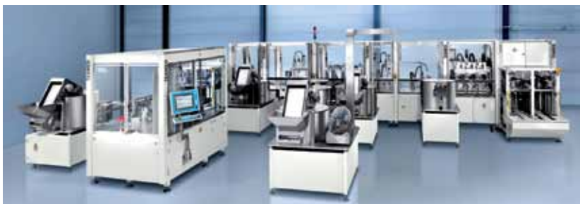
Montage- und Prüfanlage für Injektions-Pens
