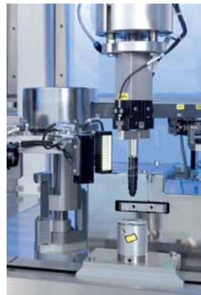
Laserbeschriftung des Skalenrohrs
