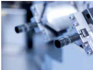
Prüfen und Einsetzen des Skalenrohrs
